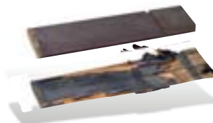
Acetylierte Scots Pine (oben) und nicht-acetylierte Scots Pine (unten) mit transparenter Beschichtung nach 5 1/2 Jahren Test im Außenbereich.
